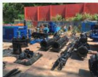
OTO 掘削機 分解時各機部材
