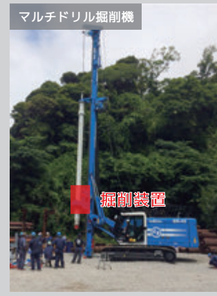
三点式杭打機との掘削装置位置の比較
