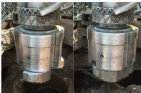
拡径ビット 拡径時（左）・収縮時（右）
