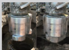
拡径ビット (拡径時・収縮時)
